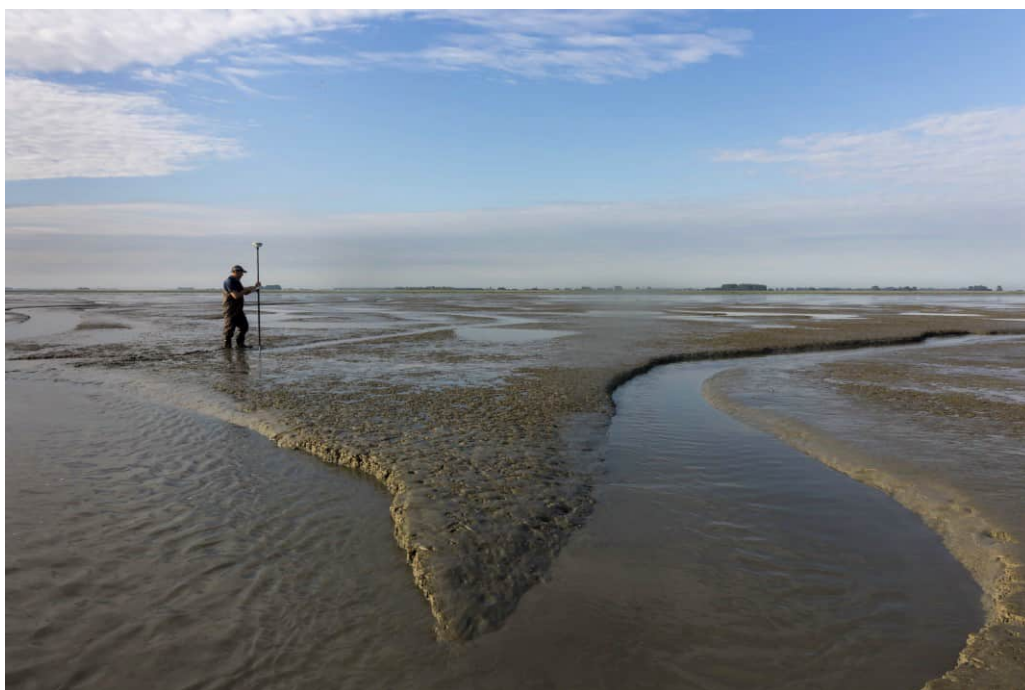
Figuur 2: Profiel inmeten met RTK
