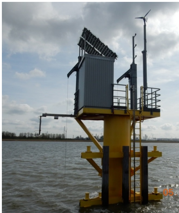
Figuur 114 – Locatie Lillo-Meetpaal met links-uitstekend arm van golvenmeter (links) en detail Log-aLevel toestel (rechts)
